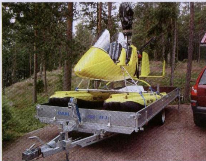
MTO Sport on kompakti paketti. Sitä voi kuljettaa tavallisella peräkärryllä. Suomeen tuotu autogiro on ensimmäinen kellukkeille asennettu MTO Sport -yksilö maailmassa.
