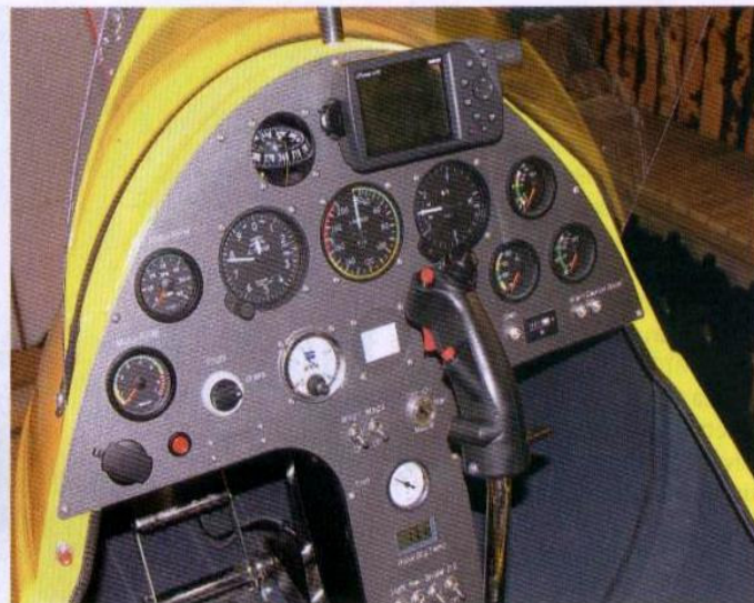
OHJAAMO on hyvin perinteinen pyöreine mittareineen. Autogirossa tärkeä roottorin pyörimisnopeuden mittari on keskivivissä vasemmalla. Gps-laitte täydentää varustelun.
