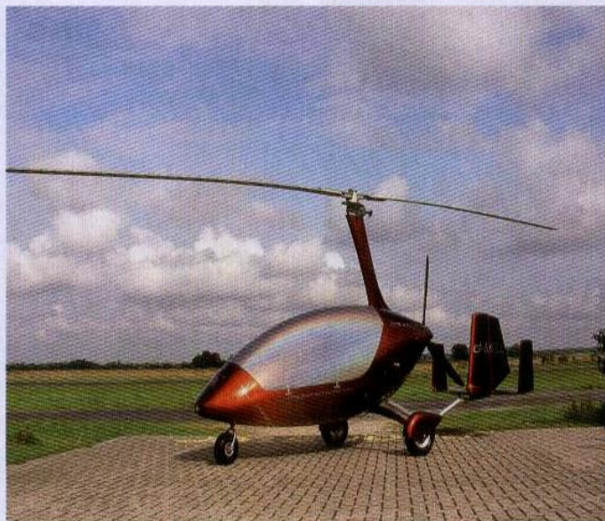
CALIDUS on HTC:n uusi, katetulla ohjaamolla varustettu jatkokehiteelmä MTO Sportista. Myös roottorimasto on koteloitu. Ohjaamossa perinteiset mittarit on korvattu nestekidenäytöillä.
